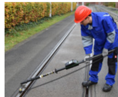
Sekundenschneller, vollständiger Eigentest für Gerätefunktion und Kontakt zur Schiene
