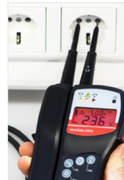
Einhandbedienung zur Prüfung von Steckdosen
