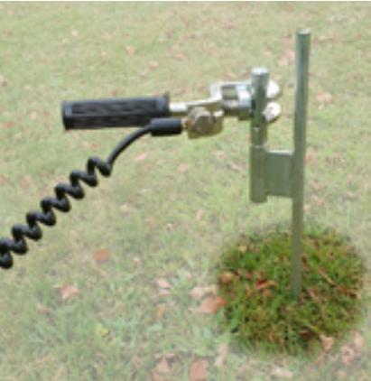
Erdverbindung mit Erdungsspieß und Universalklemme
