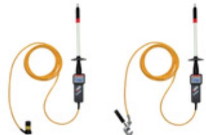
HS 5MA mit Magnet und HS 5UK mit Universalklemme zum Festanschluss an Erdpotential.
