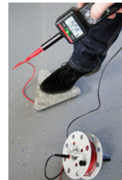
Prüfung der Ableitfähigkeit von ESD-Böden
