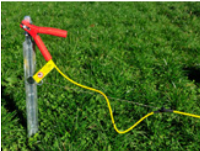
Erdanschluss, z.B. mit Erdungsspieß durch Klemme mit Zugentlastung
