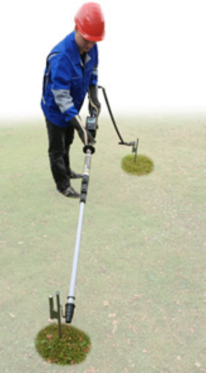
Prüfen der Erde durch zweiten Erdspieß
