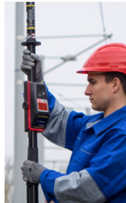
Direkte Anzeige der Spannung auf dem LCD und Warnung durch LED- und Akustik-Signal.
