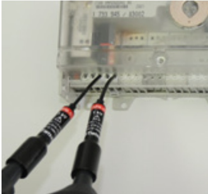
flexible Prüfspitzen für eng beieinander liegende Prüfkontakte
