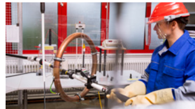
Prüfungen bis 70 kV in unserem Hochspannungslabor
