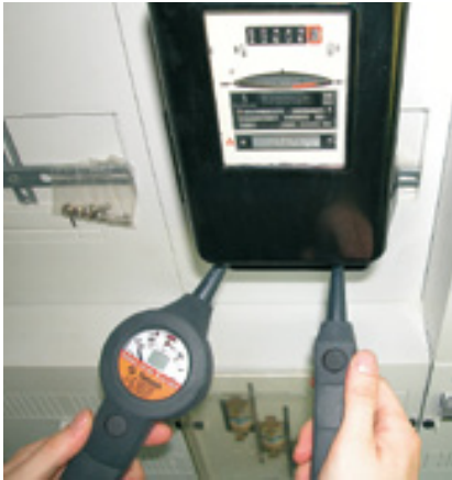
integrierte 350W-Last zum schnellen Anlauftest von Stromzählern
