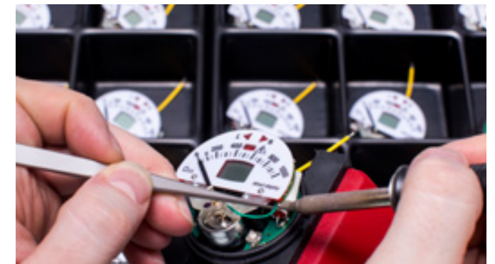
Montage hochkomplexer Messwerke
