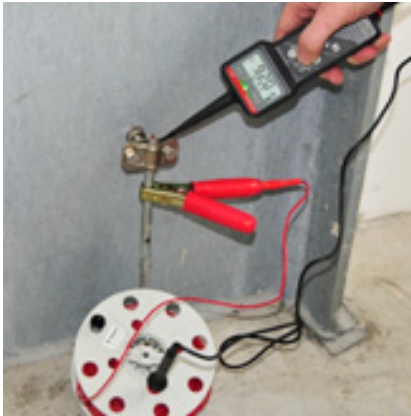
schnelle Kompensation der Messleitung
